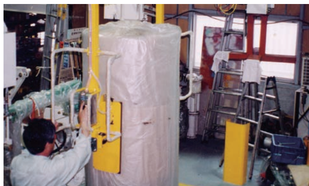
クランプ移載作業 Clamp transfer work
